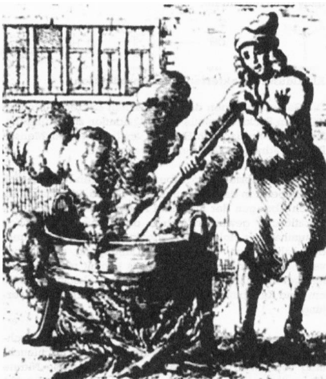
Abbildung 5: Eindampfen und Reinigung des Salpeters.
